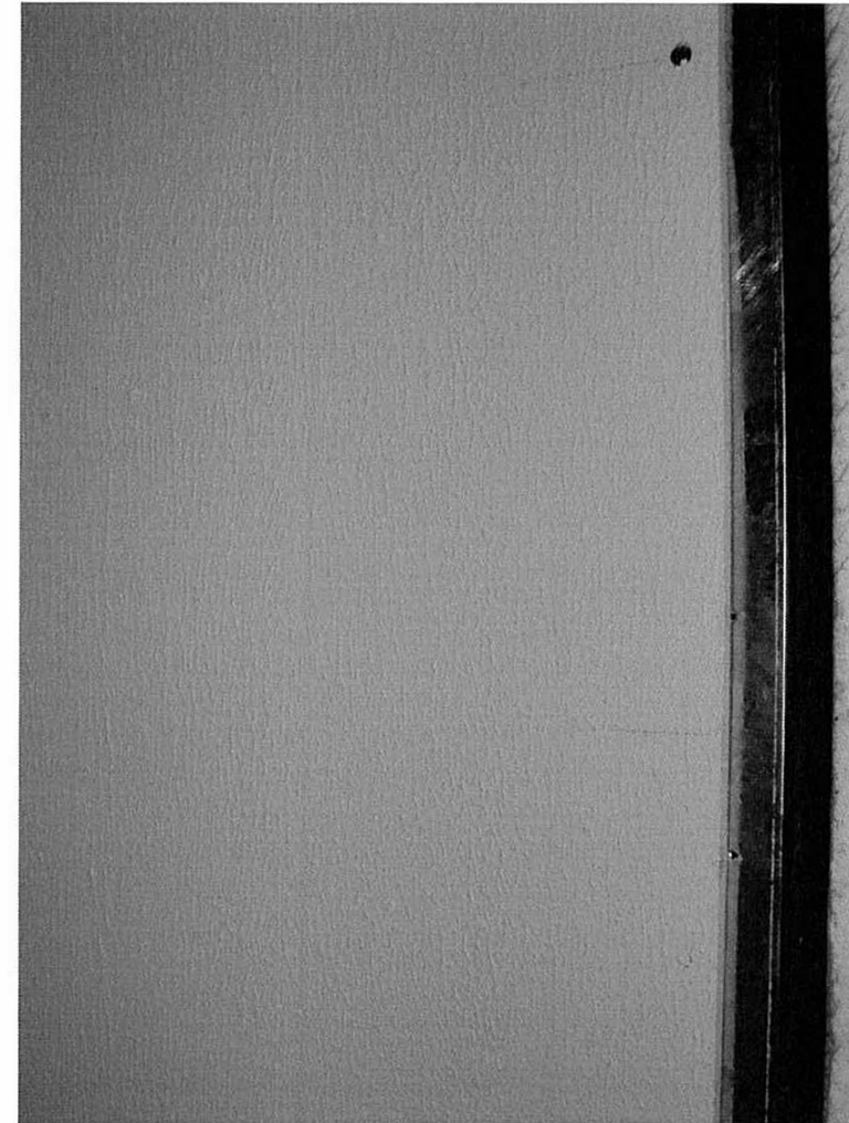
Befestigung des Prüfmaterials im SBI-Prüfstand, Versuch 1 Nahansicht der vertikalen Außenkante des breiten Probenflügels „Thermo Ceram Protect“ auf Gipskarton-Platte)
