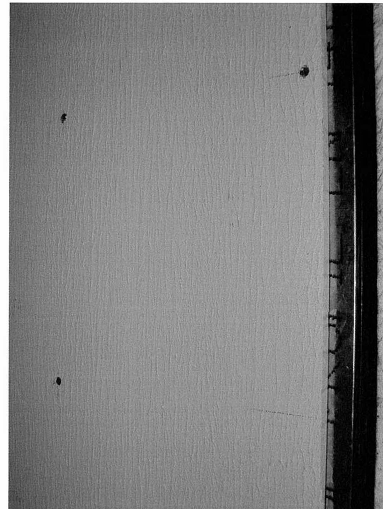
Befestigung des Prüfmaterials im SBI-Prüfstand, Versuch 3 Nahansicht der vertikalen Außenkante des breiten Probenflügels „Thermo Ceram Protect“ auf Gipskarton-Platte)
